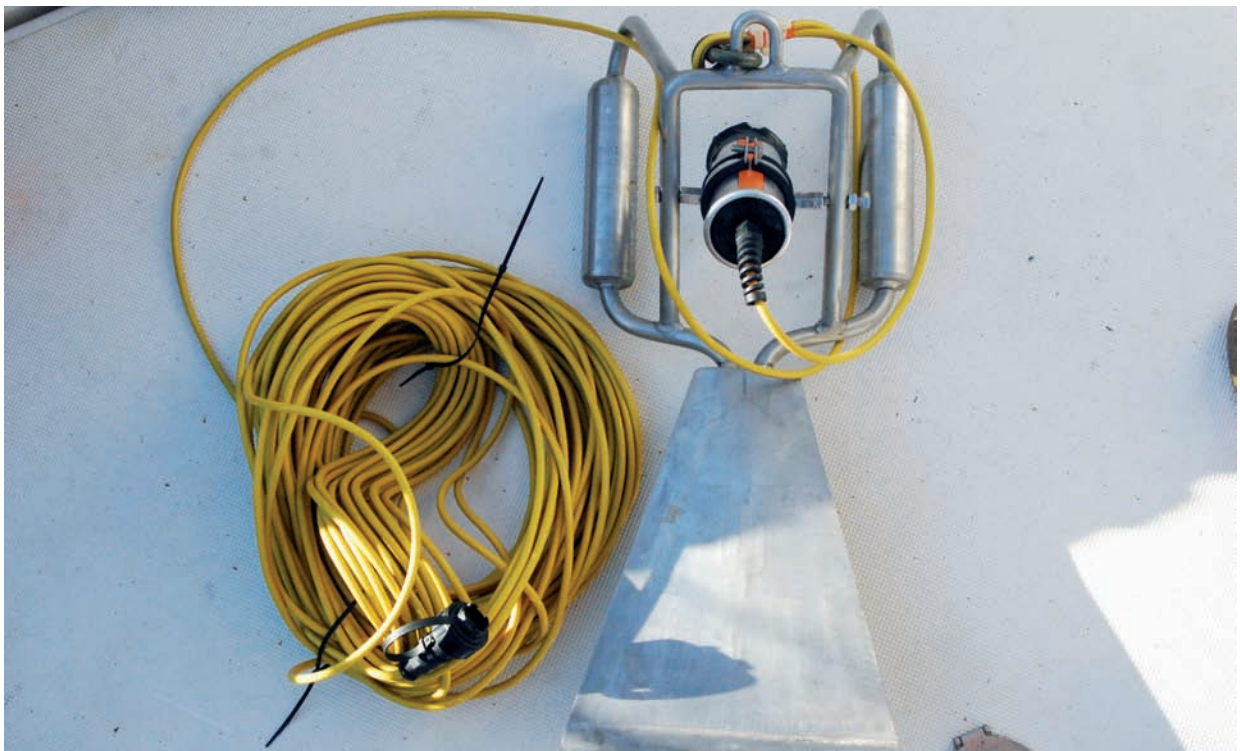
^ figura 4.11. Videocámara submarina instalada en patín y conectada a su cable umbilical.
