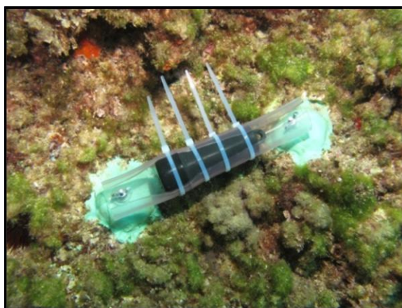
Fig. 14. Instrumento de registro de temperatura. Soporte y sensor de temperatura HOBO instalado a 17 metros de profundidad.
