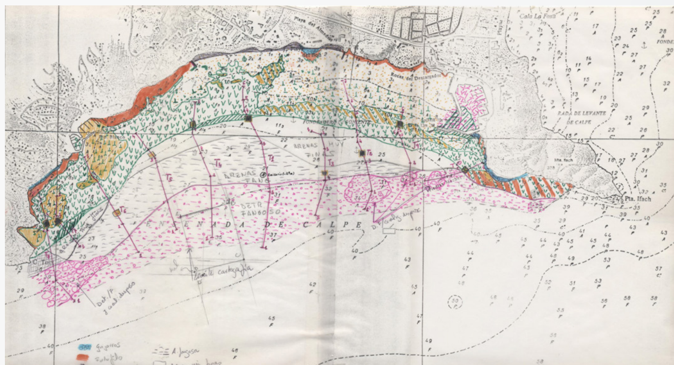
Ejemplo de elaboración de una cartografía bionómica: traslación de los datos de campo obtenidos mediante la realización de transectos en acuaplano sobre carta náutica, en la costa de Calpe (IEL, datos inéditos).
